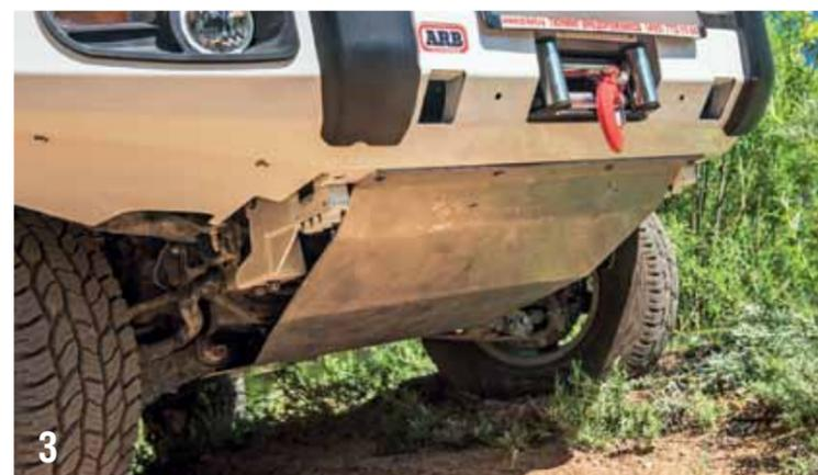
ным светом Aurora поселилась лебедка Offroad-master 12000. Задний бампер с калиткой позволил вынести запаску из-под кузова, освободив место для установки в будущем дополнительного топливного бака. Чтобы винчеваться назад, «Крузак» укомплектовали еще одной лебедкой Offroad-master на переносной площадке «РИФ» с креплением под квадрат.
